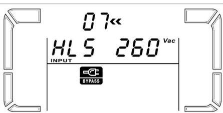
**Parametro 2:** indica se si sta operando sul valore massimo o minimo.
