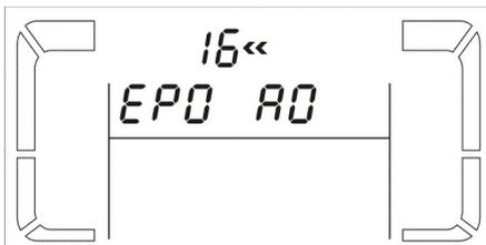
**Parametro 2:** indica che si sta operando sull'impostazione della logica di controllo della funzione EPO.
