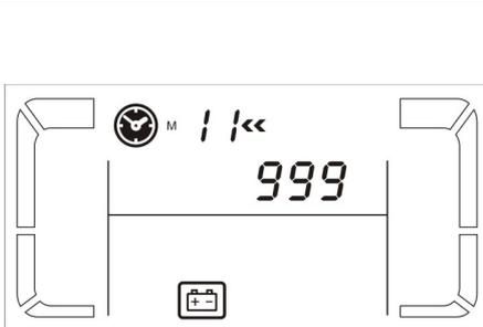
**Parametro 3:** indica il limite di tempo di autonomia per le prese di uscita.
