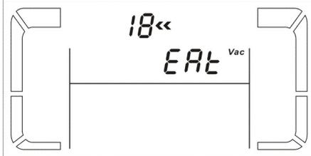
**Parametro 3:** indica che si sta operando sulla visualizzazione del tempo di autonomia.
