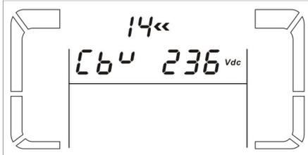
**Parametro 2:** indica che si sta operando sul valore della tensione di ricarica rapida.
