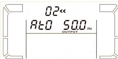
**NCF:** Se selezionato la frequenza di uscita sarà sincronizzata con la frequenza di ingresso entro i 46Hz e i 54Hz a 50Hz oppure entro i 56Hz e i 64Hz a 60Hz in accordo alle impostazioni del parametro 2. Qualora la frequenza risultasse fuori dai parametri prima menzionati, l'UPS funzionerà in modalità batteria.
