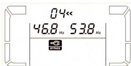
**Parametro 2:** indica che si sta operando sul valore di frequenza minima.
