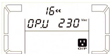
**Parametro 2:** indica che si sta operando sul valore della tensione di uscita.
