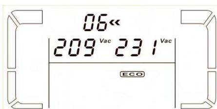
**Parametro 2:** indica che si sta operando sul valore di tensione minima.
