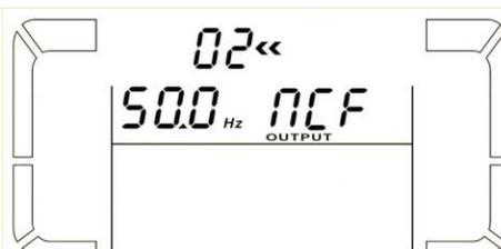
**Parametro 2:** indica il valore della frequenza di uscita, è possibile selezionare una delle tre seguenti opzioni
